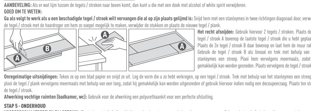
**AANBEVELING:** Als er wat lijn tussen de tegels / stroken naar boven komt, dan kunt u die met een doek met alcohol of white spirit verwijderen.
